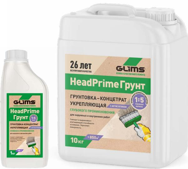
Грунтовка-концентрат GLIMS® HeadPrimeГрунт 1:5 влагостойкая с антисептиком, для укрепления и обеспыливания впитывающих оснований из бетона, пено- и газобетона, газосиликата, кирпичной кладки, штукатурок, ГКЛ, ГКЛВ и ГВЛ, наливных оснований на цементной и гипсовой основе. Применяется перед укладкой штукатурок, шпатлевок, плиточных клеев, наливных полов, декоративных финишных покрытий, поклейкой обоев и окраской. Разбавление водой до соотношения 1:5. Для наружных и внутренних работ.
